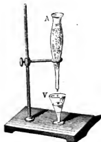
Fig. 157. — Expérience destinée à démontrer la formation naturelle du sulfate de magnésie.
